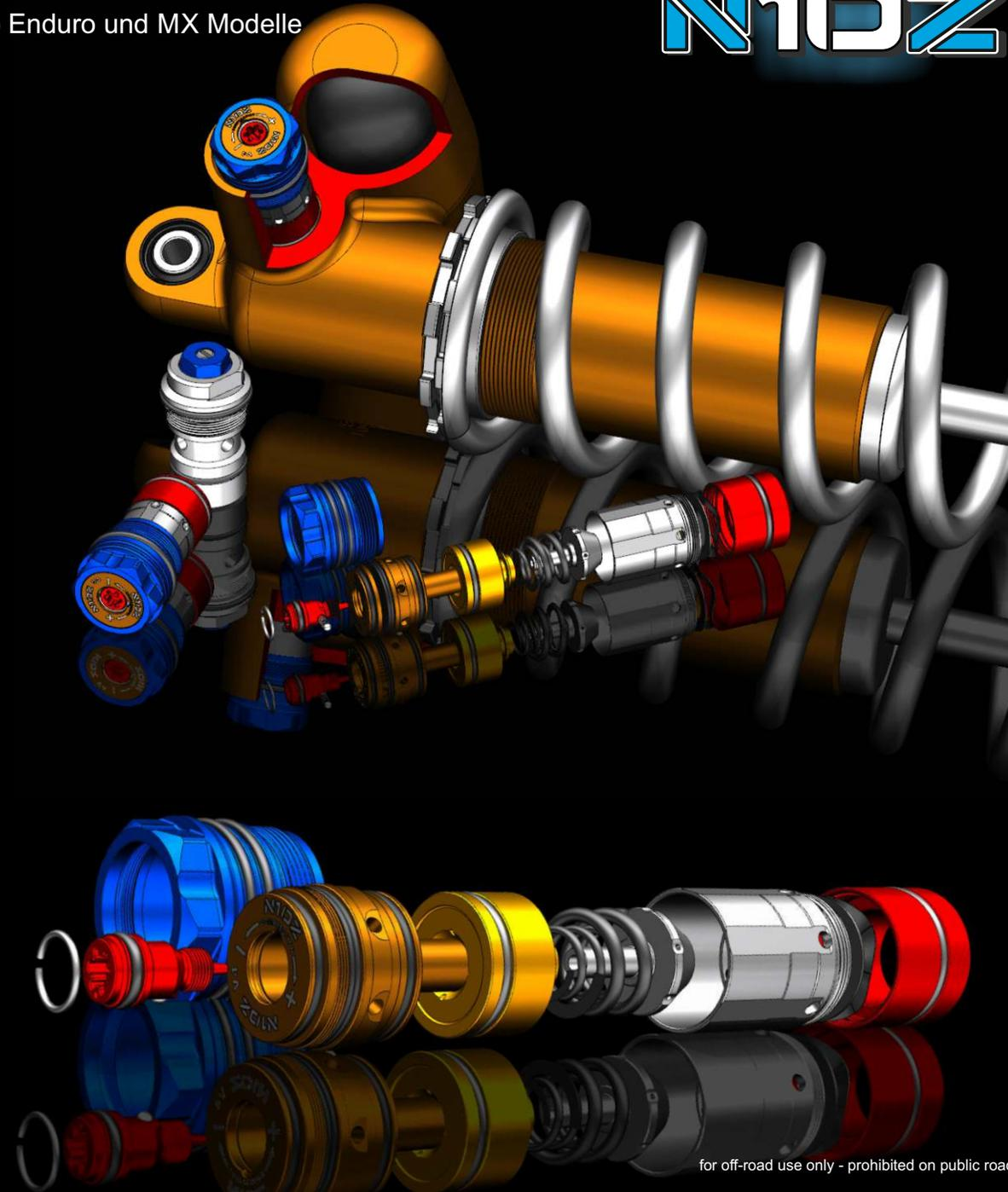
Die patentierte N10Z Technologie passt sich dynamisch/automatisch auf die Fahrzustände an. Wenn eine straffe oder weiche Dämpfung erforderlich ist, wird diese automatisch geregelt. Der Wirkungsbereich kann wie gewohnt, über die Klickerschrauben eingestellt werden.
